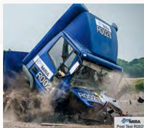
Der Poller ist nach dem Crash nicht zerstört und garantiert so immer noch Schutz.
