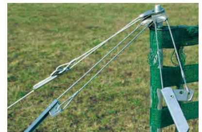
Die Längsabspannung verhindert ein Durchhängen.
