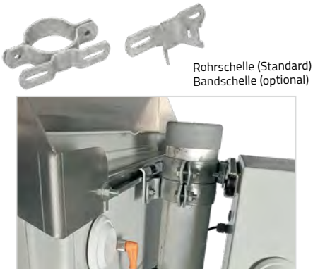
Seitenansicht der Standardbefestigung mit Rohrschellen
