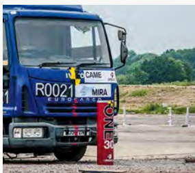
Die Hochsicherheitspoller der Serie ONE wurden nach PAS68 und IWA 14-1 in Crashtests zertifiziert.
