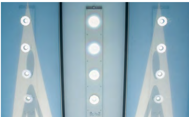
Innenleben eines innenbeleuchteten Verkehrszeichens mit LED-Technik
