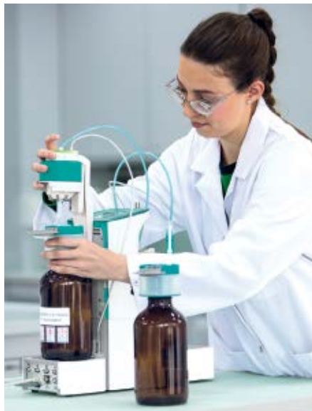
Abb. 1: Der Liquid Adapter erspart das Öffnen von Flaschen beim Reagenzwechsel und macht durch RFID-Kommunikation die Analyse rückführbar bis zum Reagenz.
